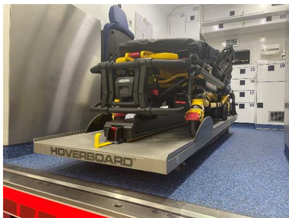
Elektrohydraulische Fahrtrage mit Hoverboard-Tragetisch
