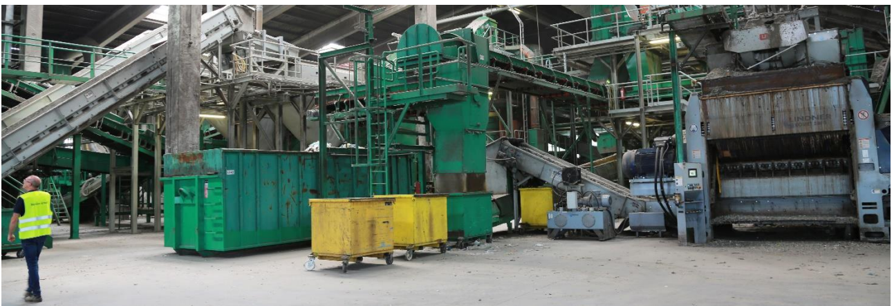
Abbildung 11: Nachzerkleinerer in der MBA-Anlage
